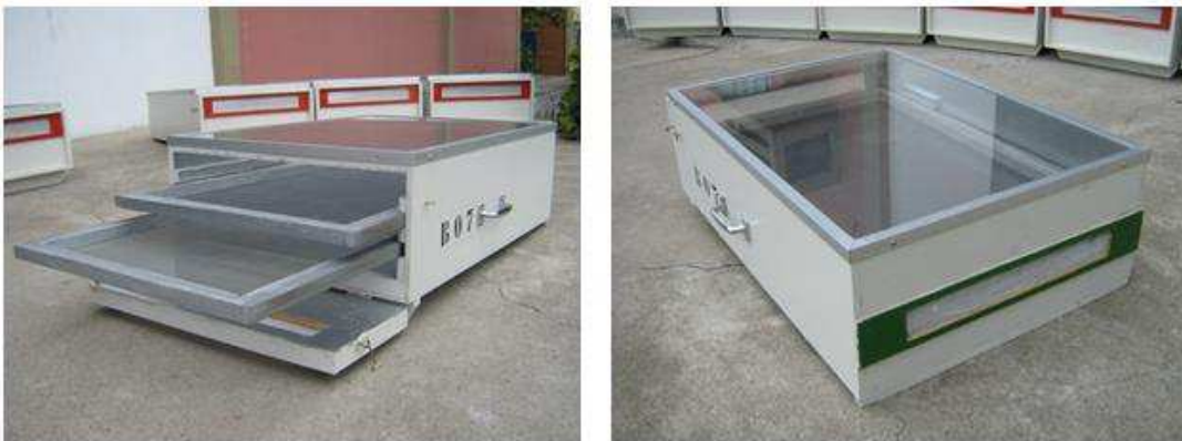
Figura 2.11 - Protótipo de secadores solares de exposição direta - GEDS/UFCG.
