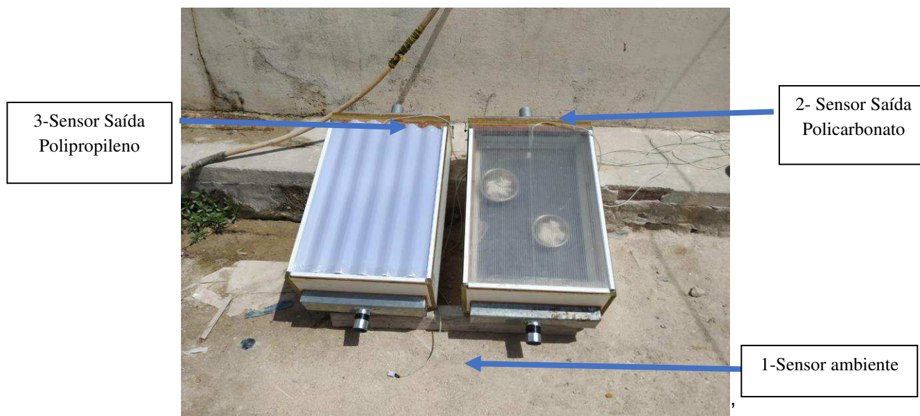
Figura 3.4 - Posicionamento dos sensores DHT22 no secador solar.
