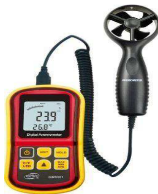
Figura 3.14 - Anemômetro digital utilizado no trabalho.
