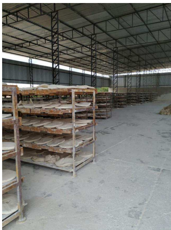
Figura 4.6 - Estrutura de secagem com utilização de prateleiras.
