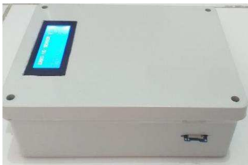
Figura 3.9 - Apresentação do compartimento para inserção do cartão SD.
