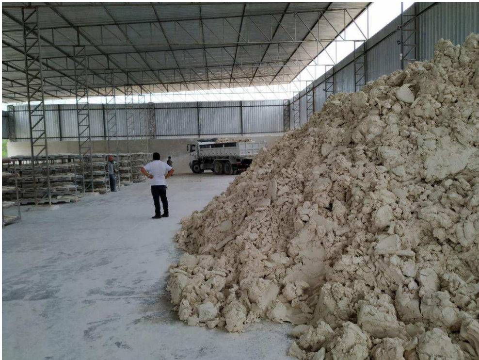
Figura 1.3 - Disposição do minério de caulim em galpão para futura secagem.
