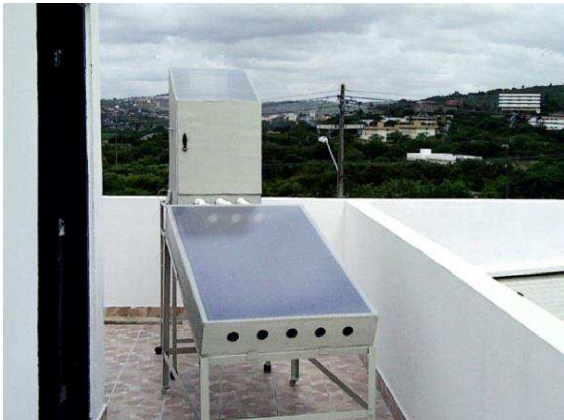
Figura 2.12 - Protótipo de secador solar de exposição indireta - GEDS/UFCG.
