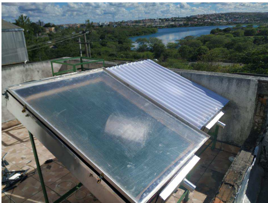
Figura 4.26 – Secador solar com diferentes coberturas no solarium do LEMT
