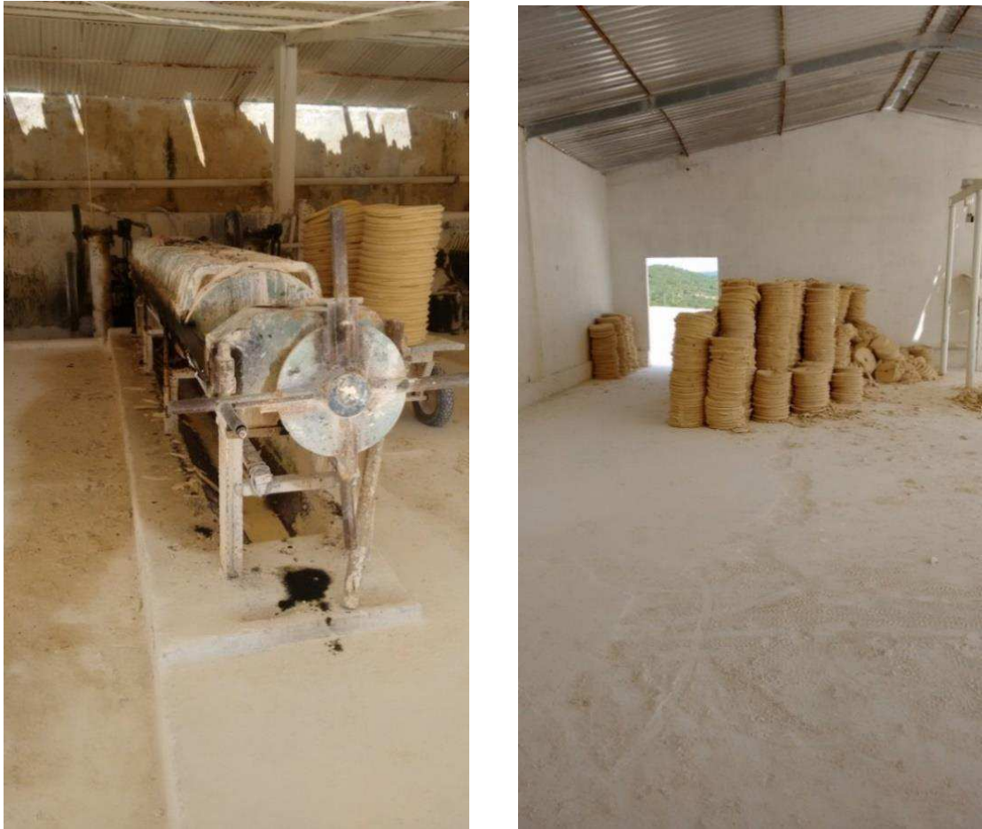
Figura 2.7 - Filtro prensa utilizado na confecção das tortas - Mineração B.
