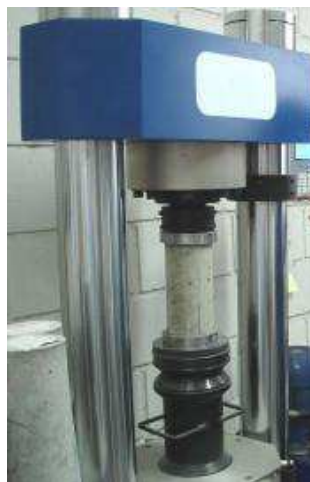
Figura 2.2 – Ensaio de resistência à compressão axial
