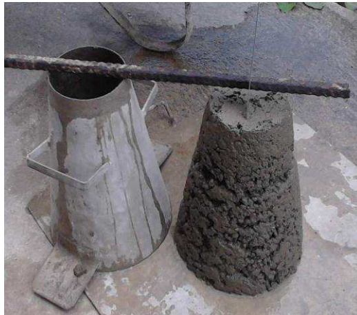
Figura 2.1 – Ensaio do abatimento do tronco do cone
