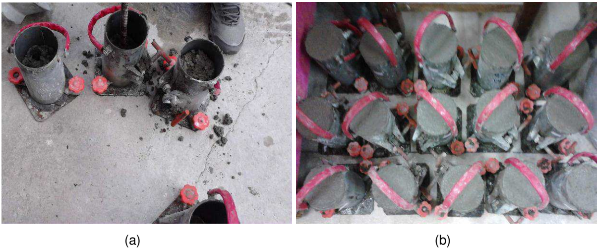
Figura 3.6 – Moldes cilíndricos sendo preenchidos com o traço determinado (a) e Moldes cilíndricos após preenchimentos com o traço determinado (b)
