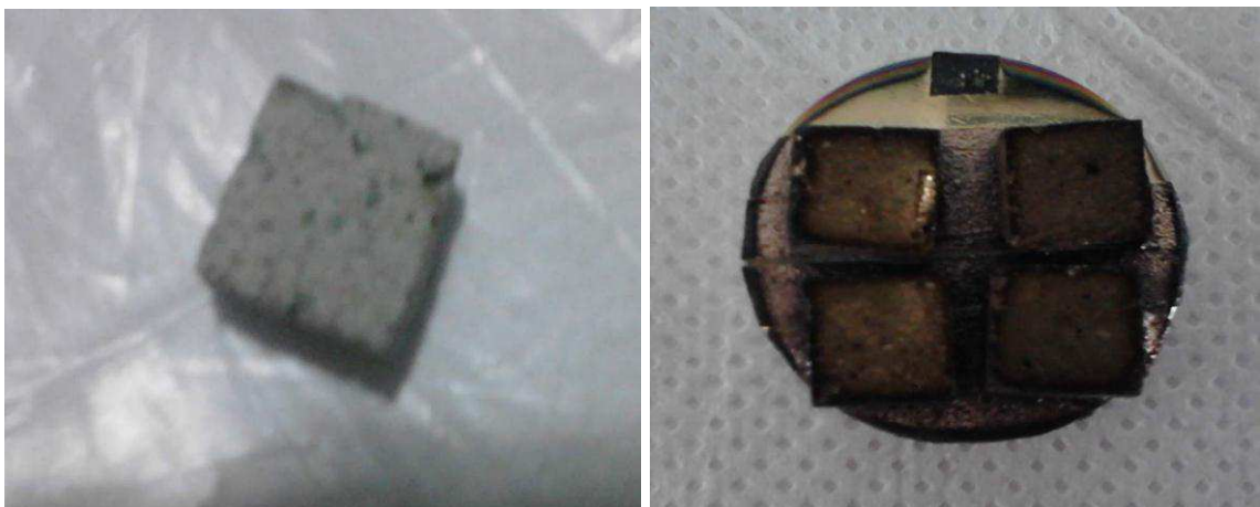
Figura 3.12 – Amostra de concreto cortada (a) e Amostras com o recobrimento de ouro (b)
