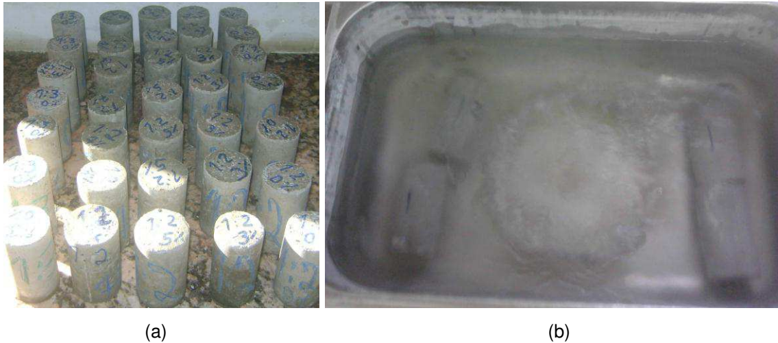
Figura 3.8 – Corpos de prova (a) e Banho Maria (b)
