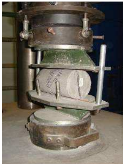
Figura 2.3 - Rompimento do corpo de prova por compressão diametral
