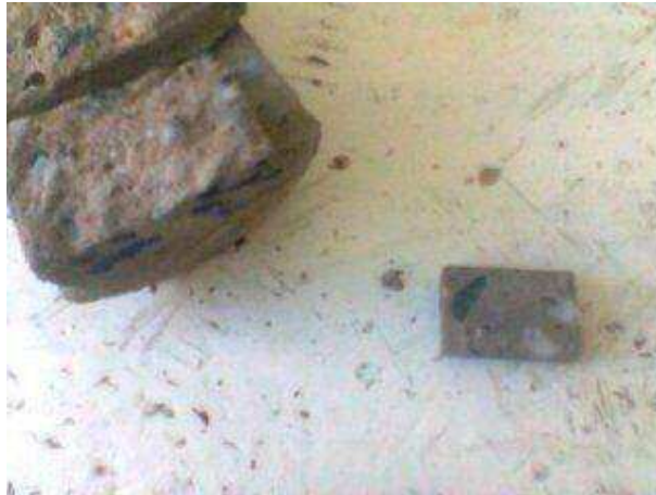
Figura 3.11- Amostra cortada do corpo de prova de concreto
