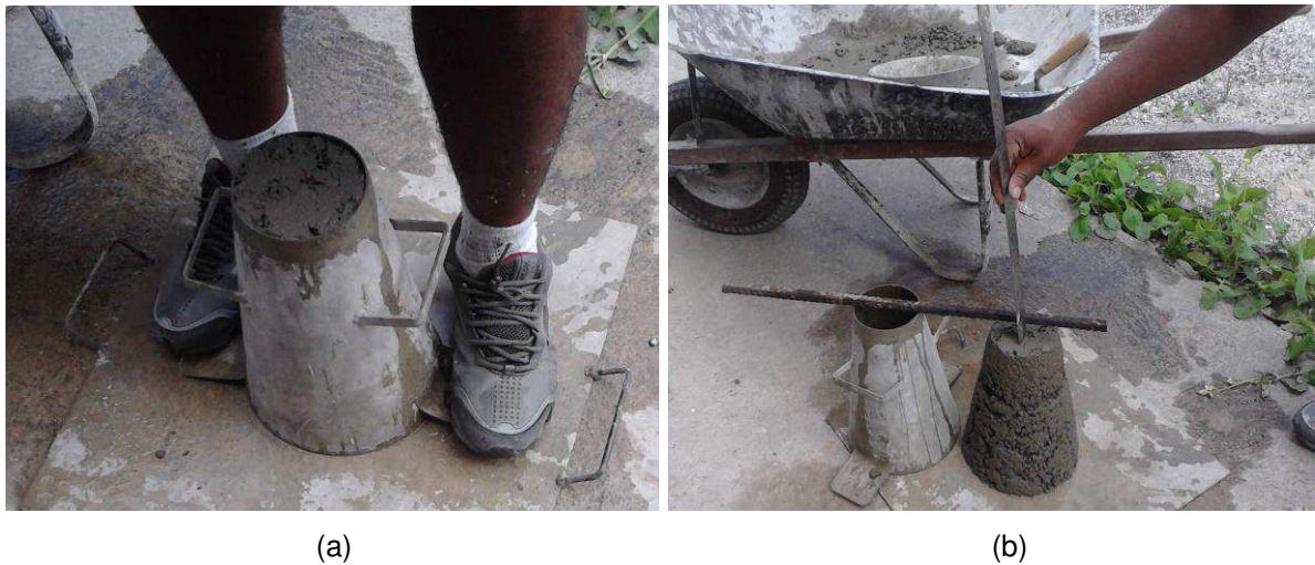
Figura 3.4 – Ensaio de abatimento do tronco de cone
