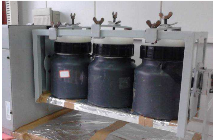
Figura 3.14 – Realização do ensaio de lixiviação com o equipamento rotativo
