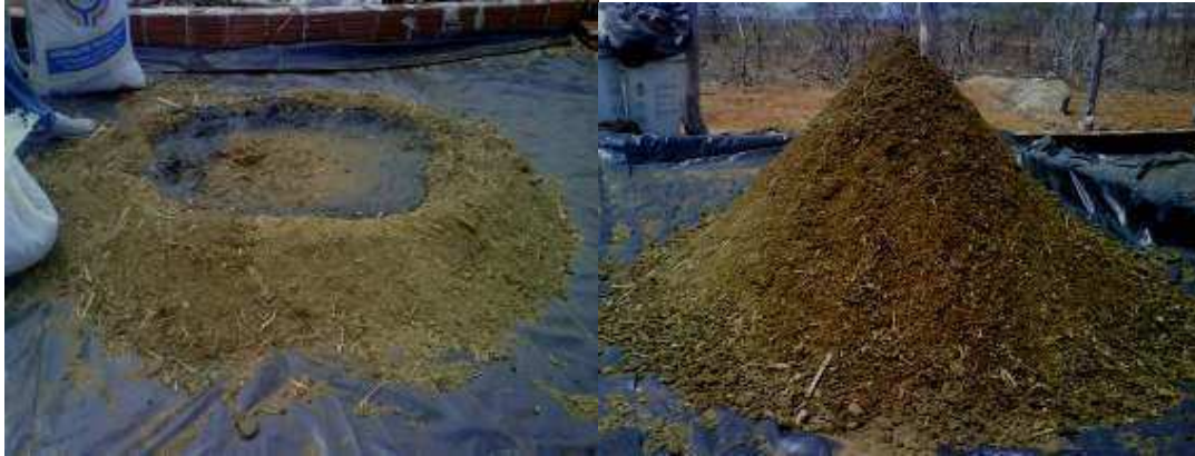
Figura 9 - Pilha de co-compostagem (Lodo de Tanque Séptico + Esterco Bovino).
