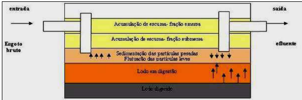
Figura 2 - Esquema de tanque séptico. Fonte: Manual da FUNASA (BRASIL, 2006).
