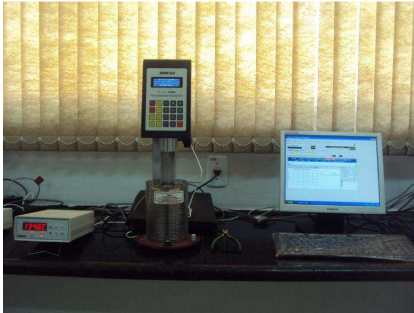
Figura 8 - Viscosímetro Rotacional - LEP/DEC/UFCG.
