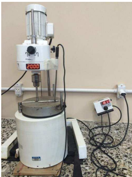
Figura 11 - Misturador Mecânico - LEP/DEC/UFCG.
