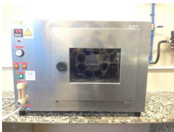
Figura 10 – Estufa para realização de ensaio de RTFO - LEP/DEC/UFCG.
