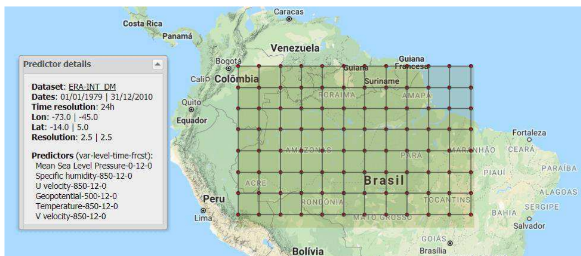
Figura 7 - Imagem da grade sobre a região Amazônia utilizada para estabelecer relações preditor (reanálises) e preditando (observações de superfície).
