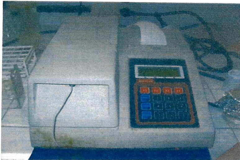
Figura 5. Determinação de Hemoglobina em aparelho Bioplus 2000 semi-automático.
