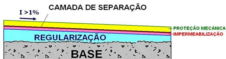
Figura 25 – Sistemas de impermeabilização 1
