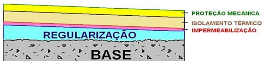
Figura 26 – Sistema de impermeabilização com proteção térmica
