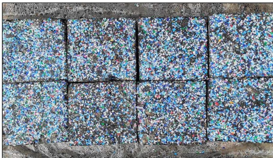
Na Figura 48, tem-se a placa de AMP 55/75, com PEAD colorindo a superfície, apontada como placa 3.
