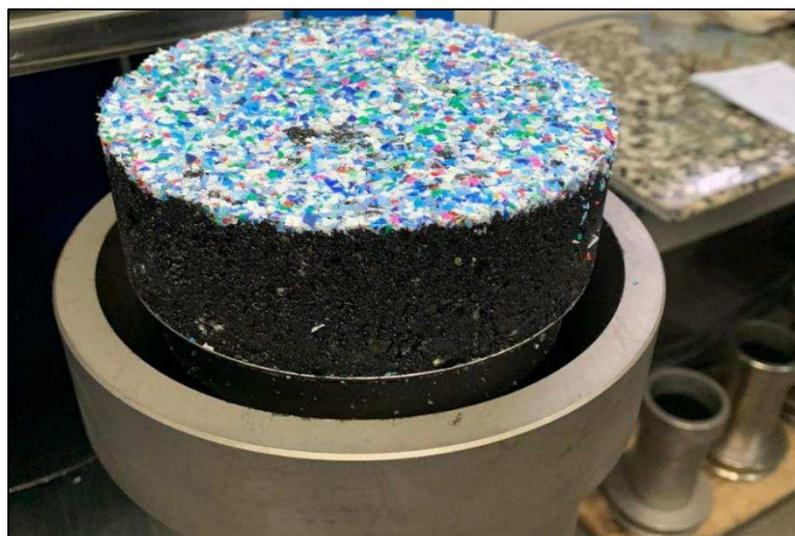
Esses CPs foram cortados com o auxílio de uma serra elétrica da marca Bosch, para remover todas as bordas dos círculos, obtendo assim um quadrado perfeito, conforme Figura 45, com vista a facilitar a montagem das placas, que posteriormente foram utilizadas para a medição da refletância e da temperatura superficial de cada amostra.
