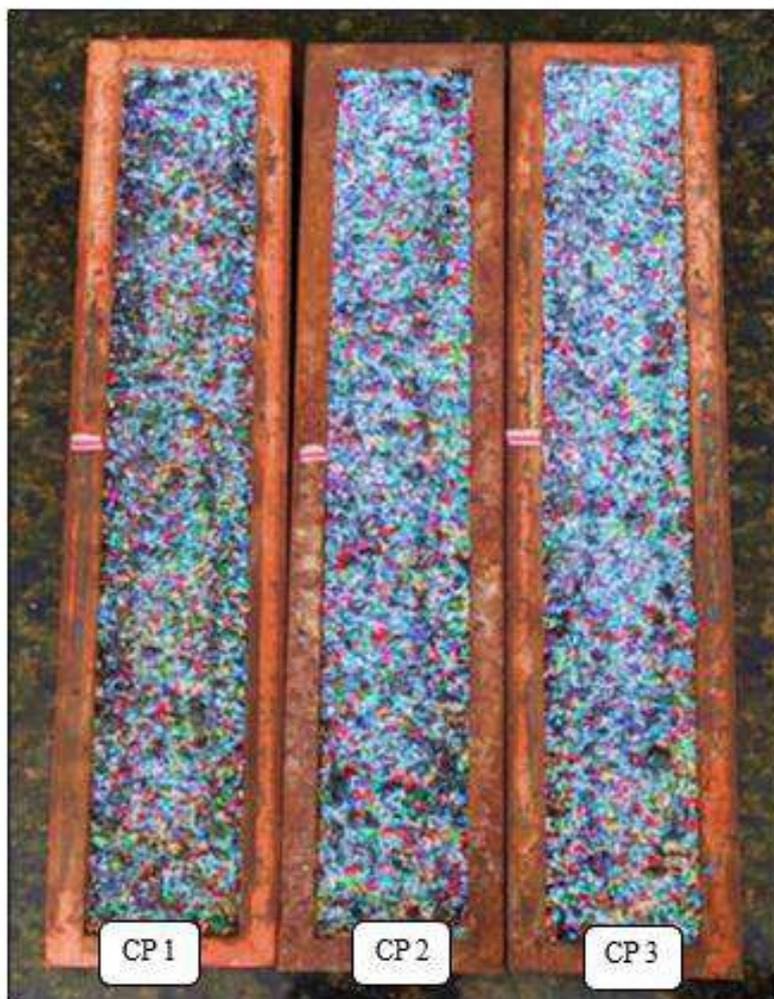
Neste ensaio foi possível notar que a temperatura de compactação, influenciou diretamente na adesão do granulado de PEAD nas superfícies das misturas, ou seja, quanto maior foi a temperatura de compactação, mais bem aderido e resistente ao desgaste ficou o PEAD na superfície.
