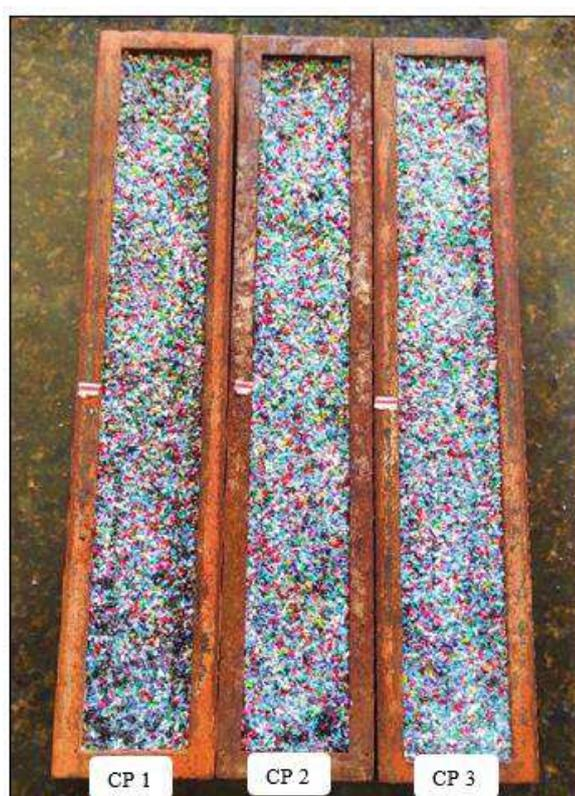
Em seguida, esses 03 CPs foram levados ao LWT, colocado um a um no equipamento, atentando-se ao alinhamento do eixo longitudinal do molde com da roda do equipamento, fixando-o com parafusos prisioneiros.
