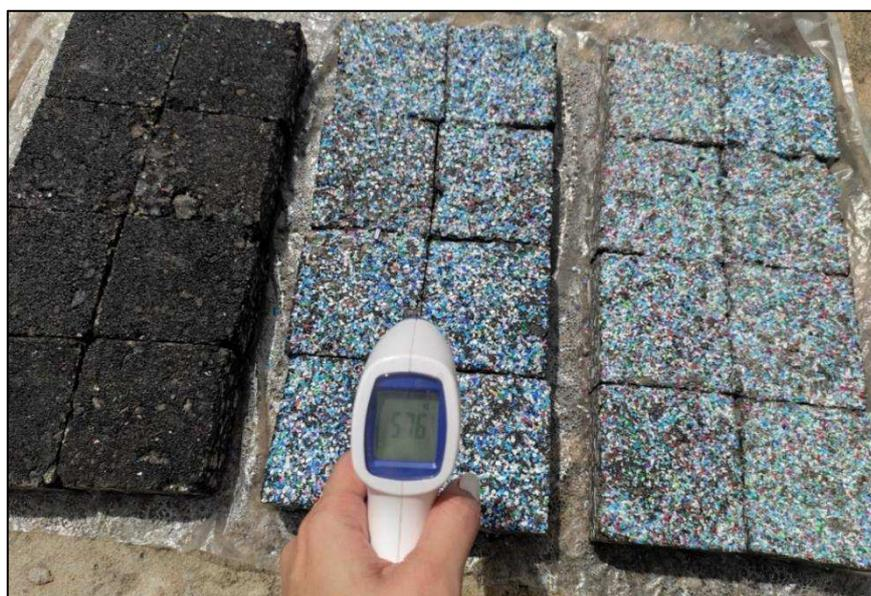
Para verificação da temperatura superficial foi aproximado o equipamento cerca de 5 cm da superfície das placas e aguardado um tempo estimado de 7 a 10 segundos para leitura da temperatura, conforme orienta o fabricante.
