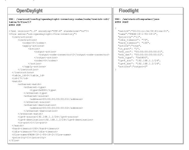
Figura 2.1: Exemplo de composição de uma mesma regra para programação da SDN com diferentes estruturas de comandos requeridas pelas APIs de controladores
