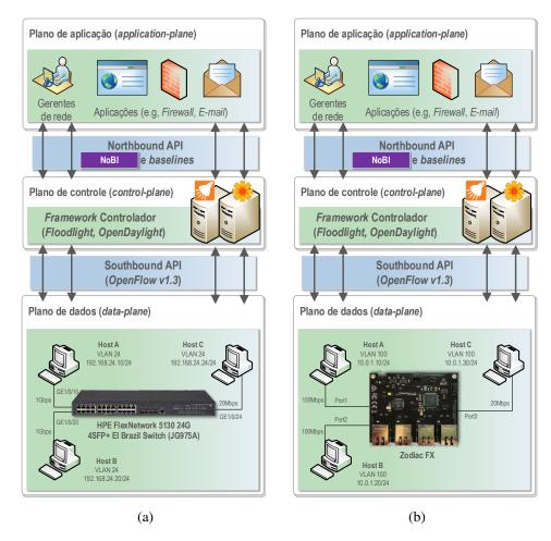
Figura 5.1: Arquiteturas de redes SDN e equipamentos *OpenFlow* usados na avaliação: (a) HPE FlexNetwork 5130 JG975A e (b) Zodiac FX SDN Development Board
