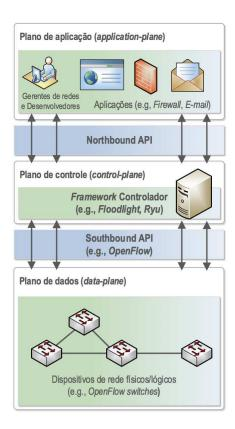
Figura 1.1: Arquitetura típica de uma rede definida por software
