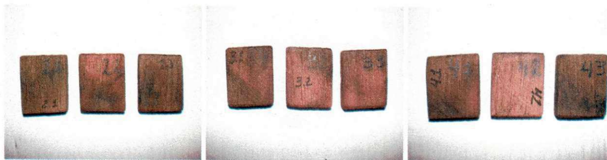
Figura 8. Corpos-de-prova de sumaúma ( Ceiba pentandra ) dos tratamentos 2, 3 e 4, que apresentaram ganho de resistência, evitando o ataque dos cupins ao ensaio de alimentação forçada
