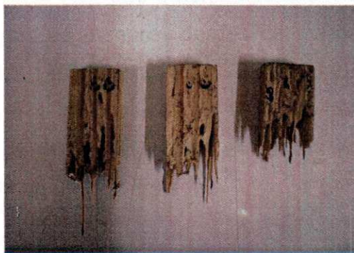
Figura 11. Corpos-de-prova de Pinus sp. apresentando falhas e rupturas após o ensaio de preferência alimentar.
