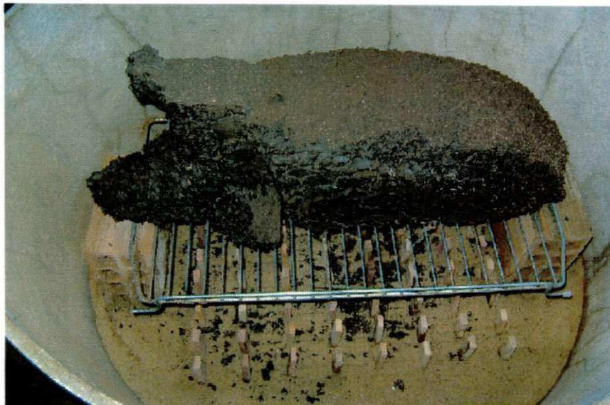
Figura 2 - Corpos-de-prova expostos à ação dos cupins.
