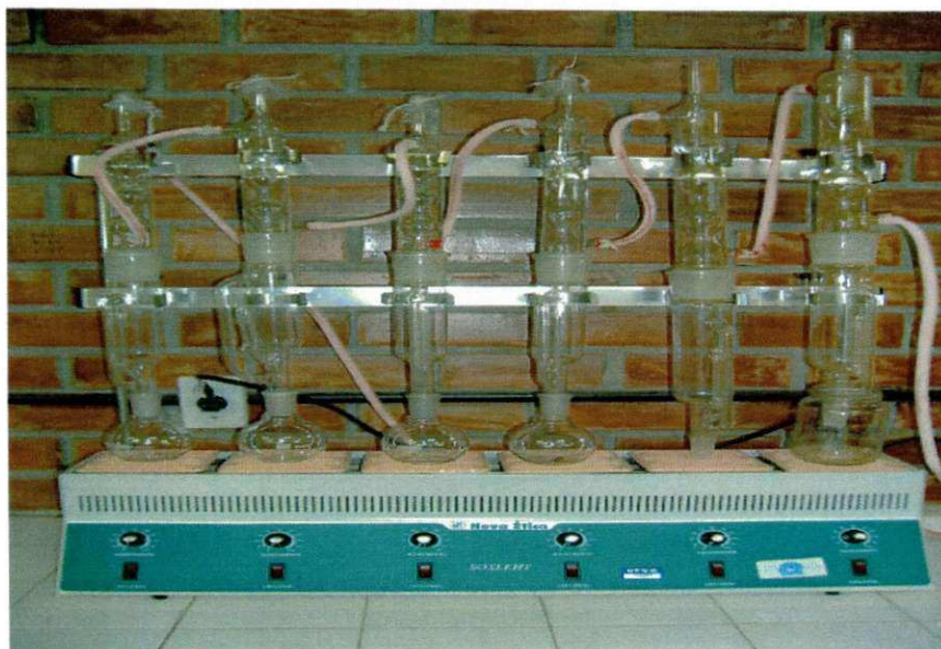
Figura 3 - Aparelho de extração tipo Soxhlet.
