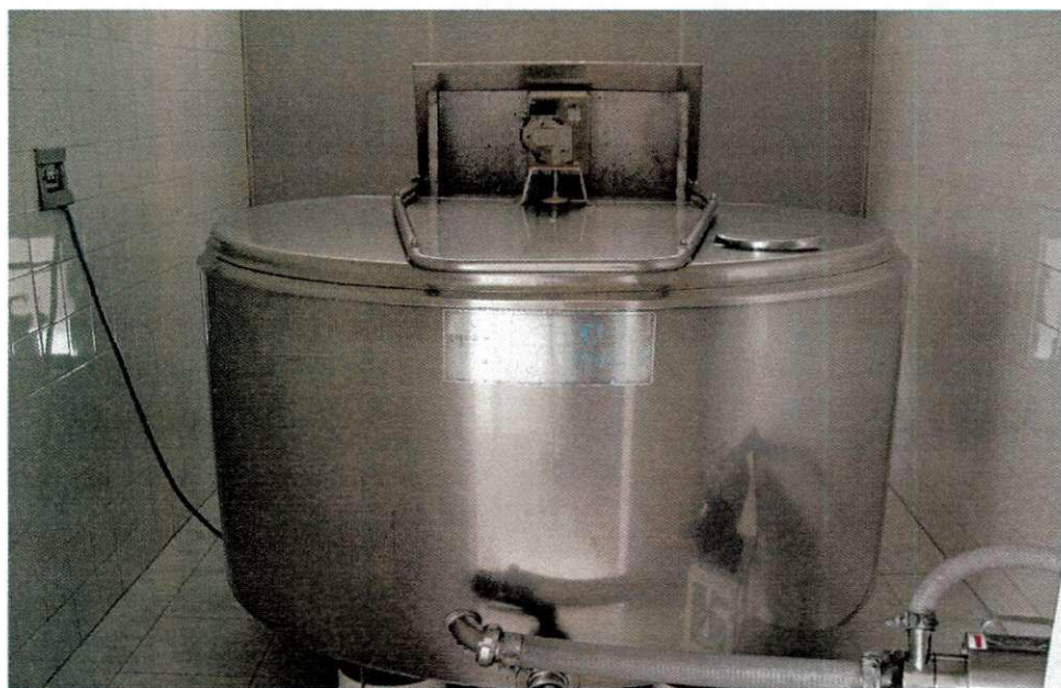
Figura 7 - Sistema de refrigeração, utilizado no resfriamento do leite.
