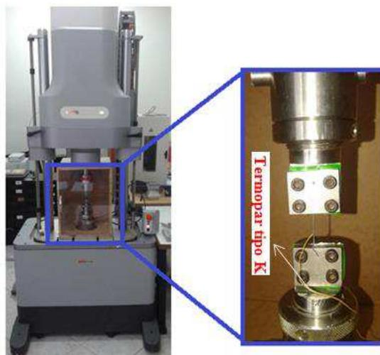
**Figura 3.8** - Máquina de ensaios universal marca Instron modelo E10000. Detalhe mostrando corpo de prova montado. **Fonte:** Autoria própria
