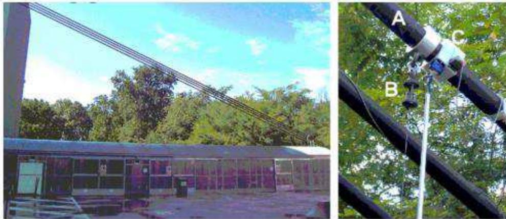
**Figura 2.16** - Vista geral dos cabos de aço de uma ponte estaiada. (A) Cabos. (B) Dispositivo de LMF de NiTi. (C) Instrumentação eletrônica utilizada. **Fonte:** TORRA et al. (2013)
