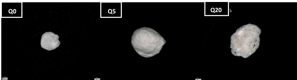
Figura 9 – Imagens das esferas no MO com aumento de 40X. (Q0) Esferas de quitosana, (Q5) Esferas quitosana +5% EAB e (Q20) Esferas quitosana +20% EAB (AUTOR, 2017).
