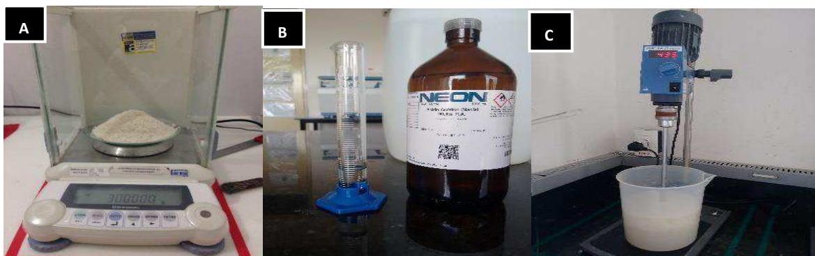
Figura 5 – Pesagem da Quitosana (A), Medição de 15 ml do ácido acético glacial 1% (B), e Solução de Quitosana com ácido acético sob agitação mecânica (C) (AUTOR, 2017).
