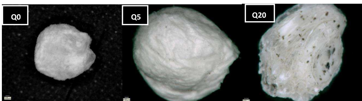
Figura 10 – Imagens das esferas no MO com aumento de 100X. (Q0) Esferas de quitosana, (Q5) Esferas quitosana +5% EAB e (Q20) Esferas quitosana +20% EAB (AUTOR, 2017).
