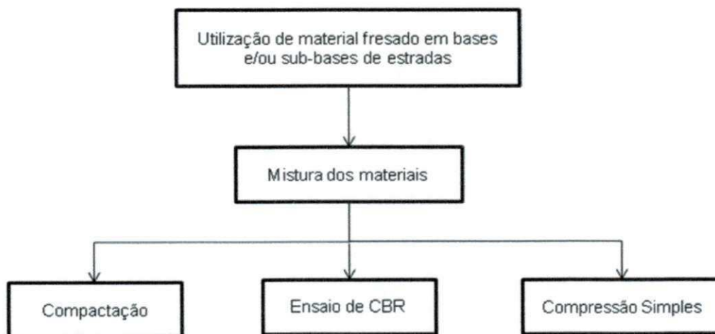
Fluxograma 2 – Sequência de atividades utilizadas para avaliar as propriedades mecânicas do solo e das misturas de materiais utilizados na pesquisa.
