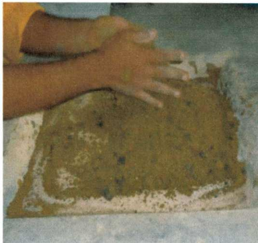
Figura 3.7 – Mistura do solo, material fresado e aglomerante.
