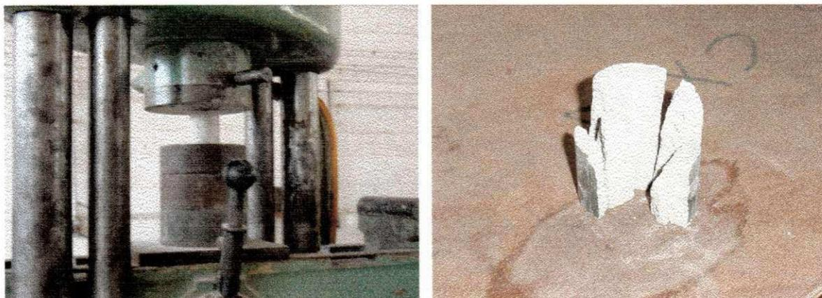
Figura 3.4 – Fotos do ensaio de resistência a compressão e do corpo de prova após rompimento.
