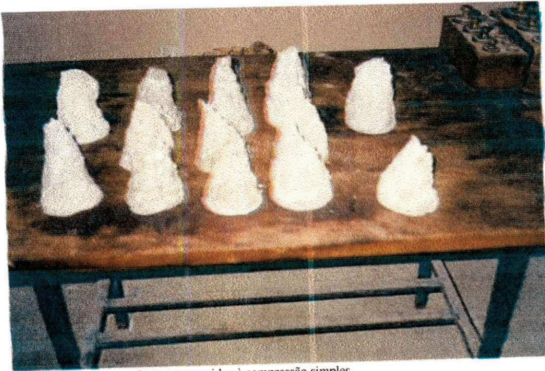
Figura 3.3 – Corpos de prova rompidos à compressão simples.
