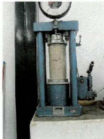
Figura 19 - Rompimento do corpo-de-prova com casca de arroz à compressão.
