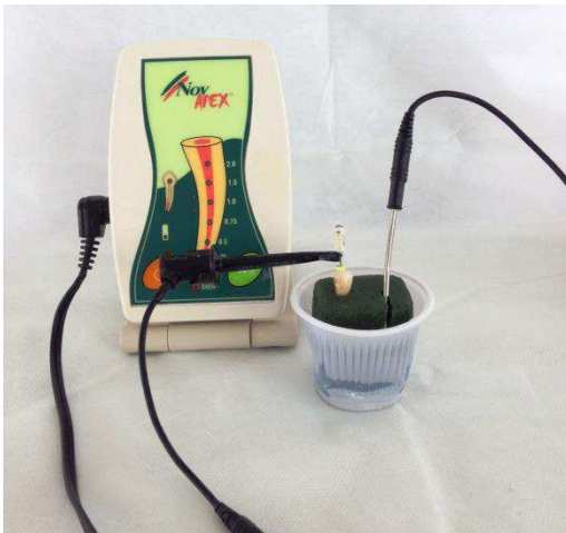
Figura 3 – Base experimental com elemento Dental e alça labial posicionados para medição eletrônica no Novapex.
