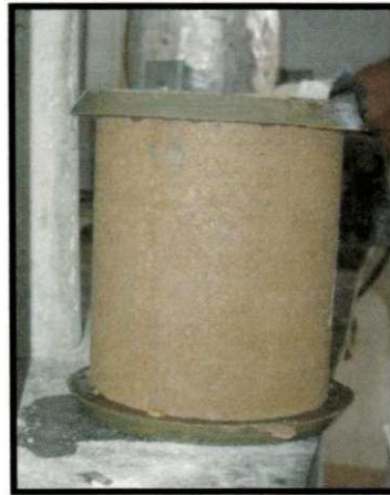
Figura 3.11: Corpo-de-prova pronto para ensaio de RCS.
