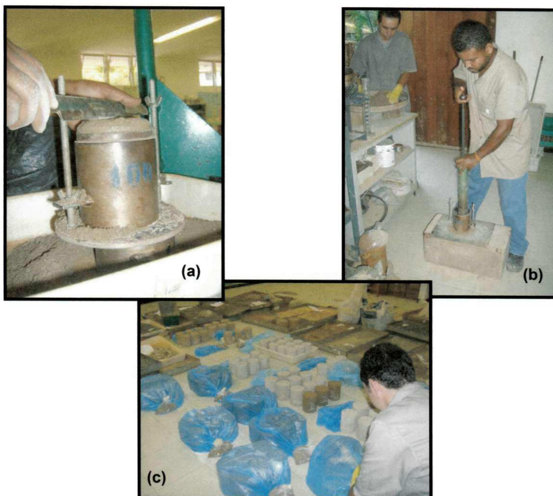
Figura 3.10: (a) Molde cilíndrico, (b) Ensaio de compactação, (c) Acondicionamento e cura dos corpos-de-prova.
