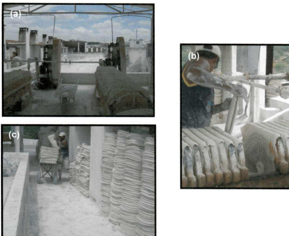
Figura 2.11: (a) Seqüência em paralelo com bombas de recalque para filtração através de filtros-prensa, (b) Retirada dos blocos de caulim para estocagem e secagem, (c) Armazenagem em pilhas dos blocos de caulim para secagem prévia.
