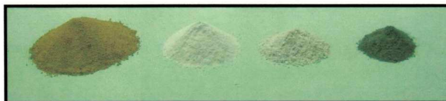
Figura 3.8 Materiais para as misturas de solo-cimento e SCR caulim .
