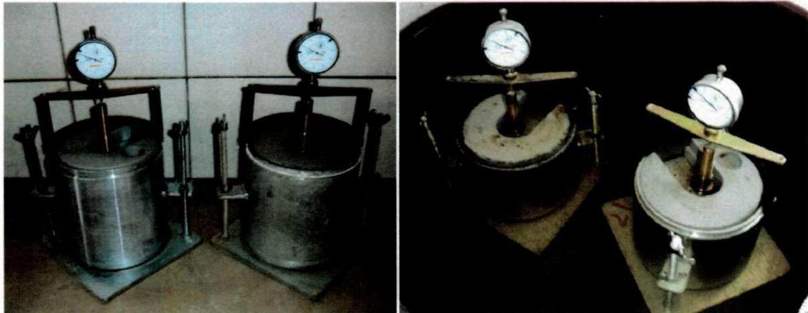
**Figura 3.7 - Equipamentos utilizados para realização dos ensaios de expansão**
