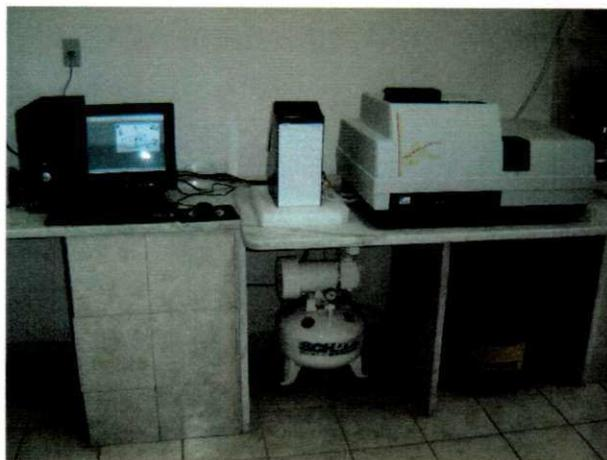
**Figura 3.4 – Granulometro à laser CILAS 1064**
