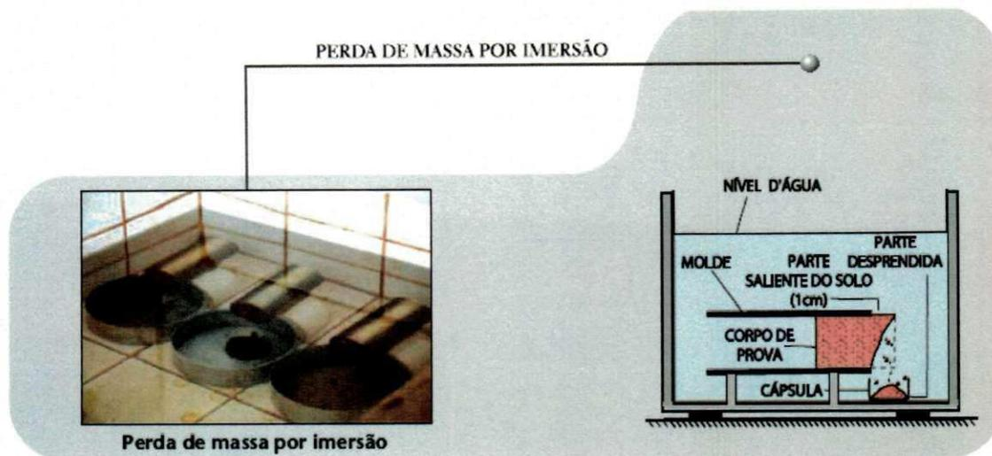
Figura 3.9 – Croqui do Ensaio de Perda de Massa Por Imersão (Nogami e Villibor, 2009)
