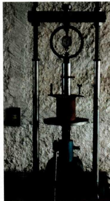
**Figura 3.8 - Equipamentos utilizados para a realização dos ensaios de compressão simples**
