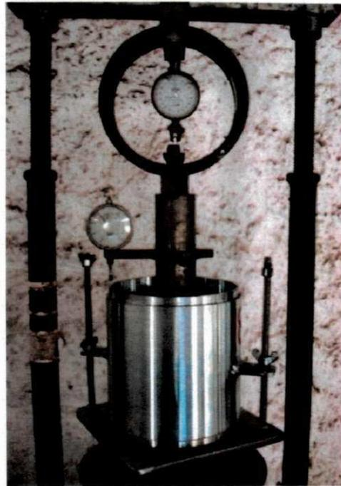
**Figura 3.6 – Equipamentos utilizados para realização dos ensaios de CBR**
