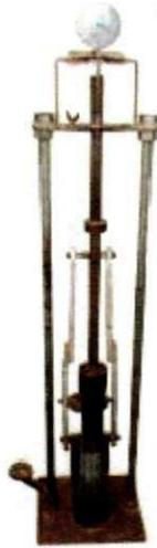
**Figura 2.4 - Modelo de compactador miniatura da utilizado na metodologia MCT (Escola de Engenharia de São Carlos – USP, 2006)**
