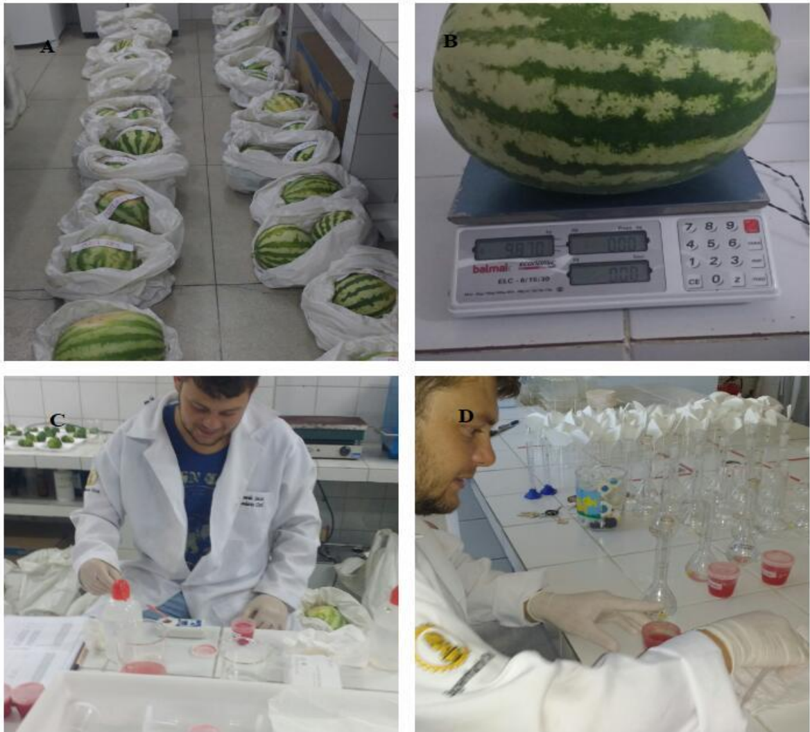
Figura 3- Análise de partição de massa (A); Pesagem do fruto para produtividade (B); Análise de Sólidos Solúveis (SS) (C); Análise de ácidos titulável (D).
