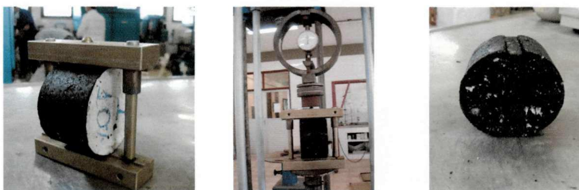
Figura 3.11: Ensaio de Resistência à Tração (RT) (a) pórtico (b) ruptura do corpo de prova (c) corpo de prova pós rompimento
