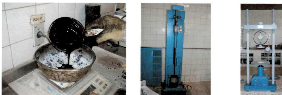
Figura 3.10: Ensaio para determinação da Estabilidade Marshall (a) execução da mistura (b) compactador automático (c) prensa Marshall
