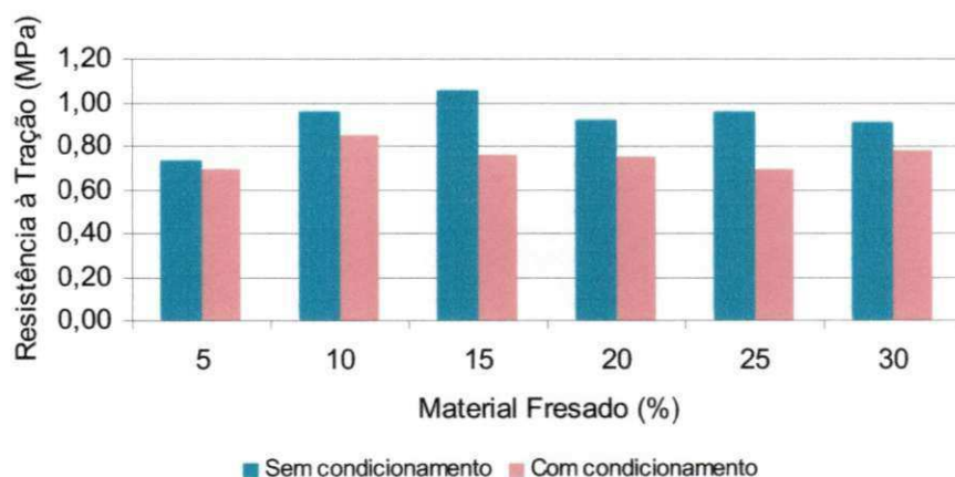
Figura 4.21: Resistência à tração com e sem condicionamento – Compactação Marshall
