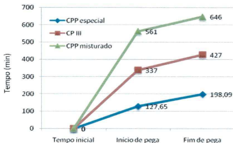
Figura 42 - Tempo de pega: CP III, CPP Misturado e CPP Especial.
