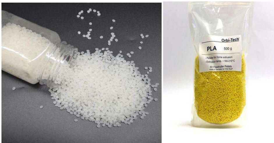
Figura 24: Pellets , grãos plásticos produzidos ao final da etapa de extrusão.
