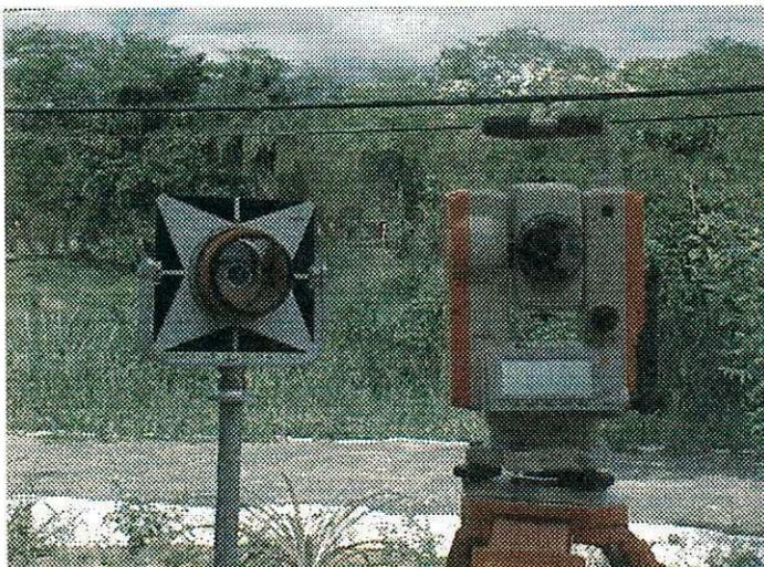
Figura 7: Estação total e prisma
