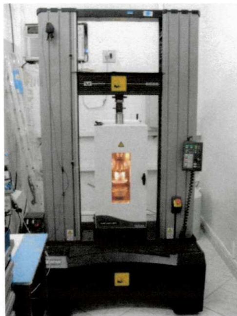
Figura 50 – Máquina de ensaios INSTRON 5582, equipada com câmara de aquecimento controlado.
