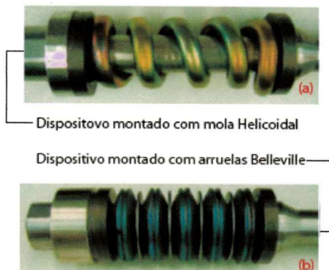
Figura 39 - Dispositivos para recentragem de edifícios submetidos a abalos sísmicos. (a) Dispositivo com mola helicoidal de LMF. (b) Dispositivo com arruela Belleville de LMF. (Adaptado de SPEICHER et al , 2009).
