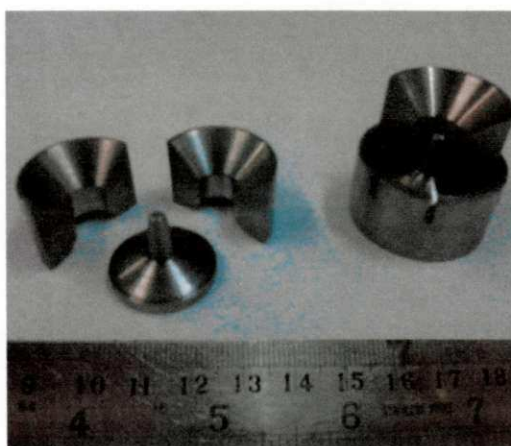
Figura 46 – Molde em aço inox ( M_{BEL} ) para obtenção do AMF_{CON} .
