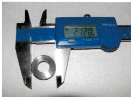
Figura 48 - AMF CON obtido a partir do processo de usinagem convencional.
