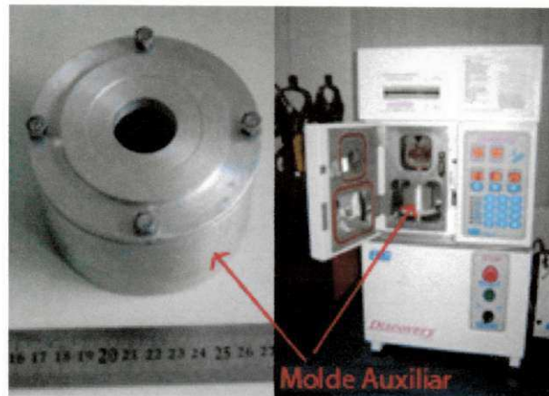
Figura 44 – Molde auxiliar ( M_A ) utilizado para adaptação do processo PSPP.
