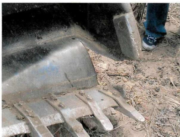
**Figura A.3** Detalhe do rasgo da concha da retroscavadeira.
