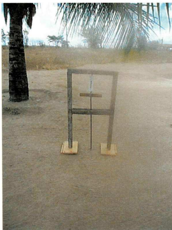
Figura 38: Penetrômetro construído na propriedade
