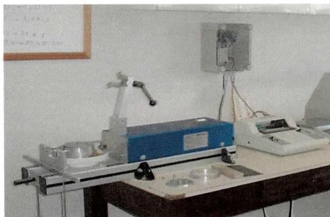
Figura 8: Aparelho de cisalhamento “Jenike shear cell”
