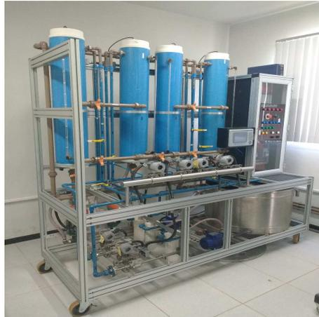
Figura 6.7: Plataforma Experimental - Quatro tanques acoplados
