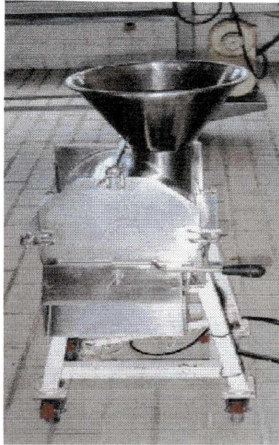
Figura 3 – Despolpadeira utilizada no processamento da manga.
