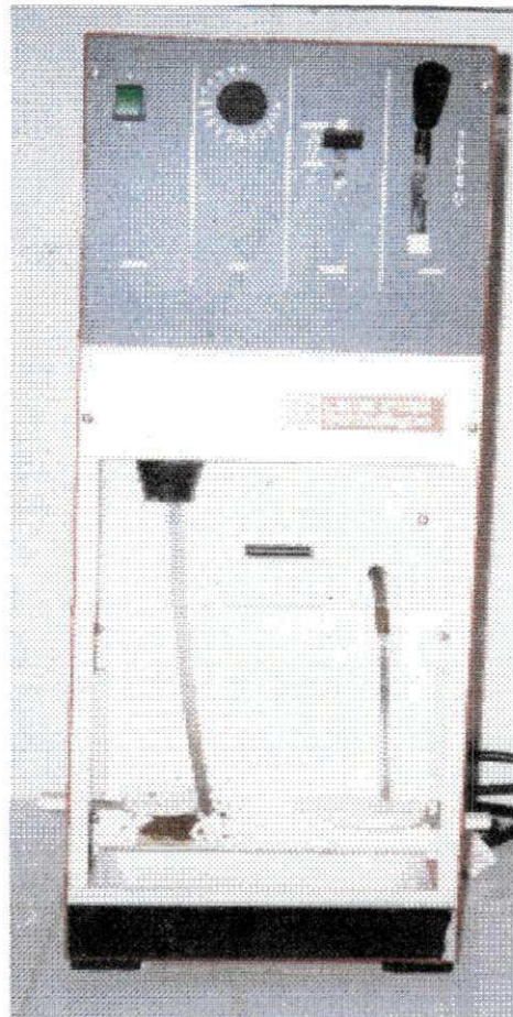
Figura 6 – Destilador utilizado na determinação do teor protéico.
