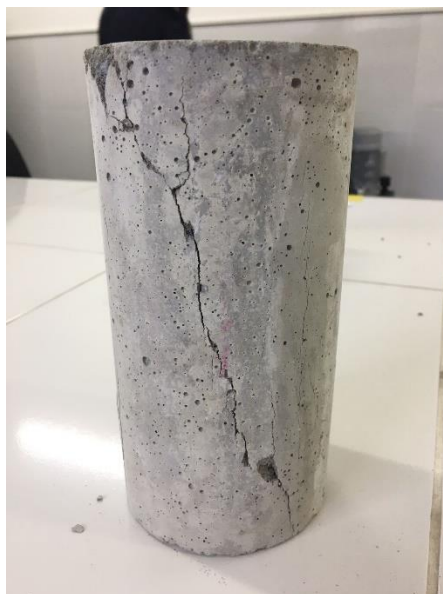
Figura 25 - Corpo de prova após ensaio de resistência a compressão.
