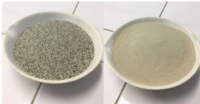
Figura 2 - Resíduo grosso e fino de scheelita, respectivamente.
