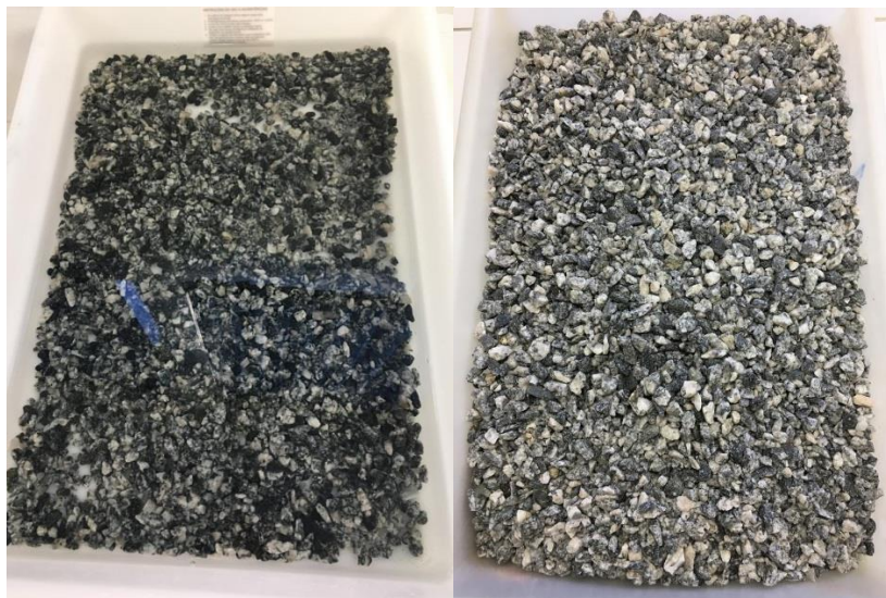
Figura 7 - Ensaio para determinação da densidade e absorção de água da brita.
