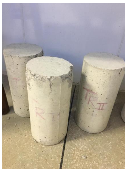
Figura 24 - Corpos de prova do traço 1 após ensaio.
