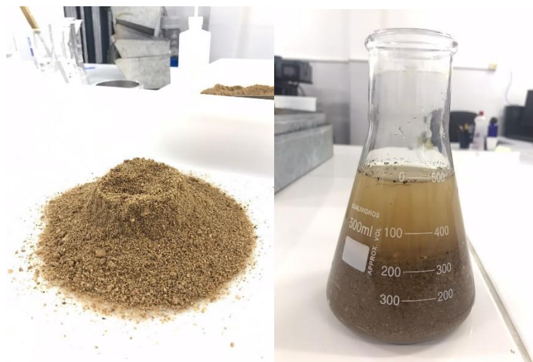
Figura 8 - Ensaio de densidade da areia.
