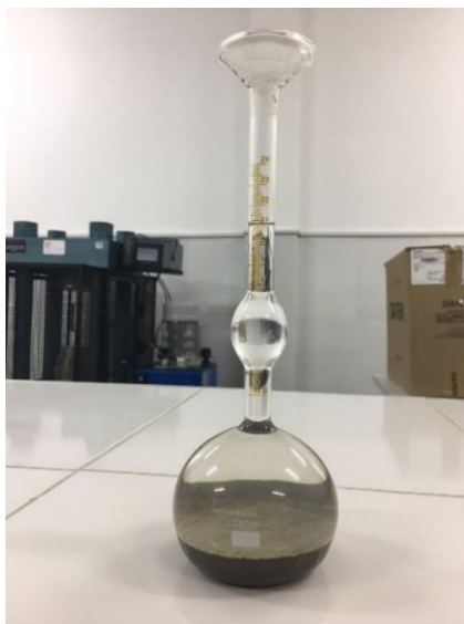
Figura 6 - Ensaio de massa específica do cimento.
