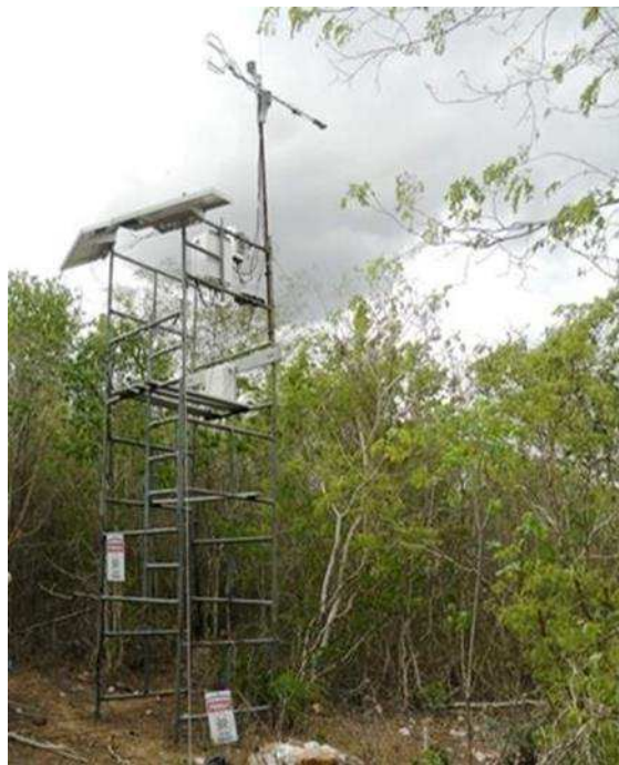
Figura 7 – Torre micrometeorológica instalada na área de Caatinga recuperada em Campina Grande no estado da Paraíba.
