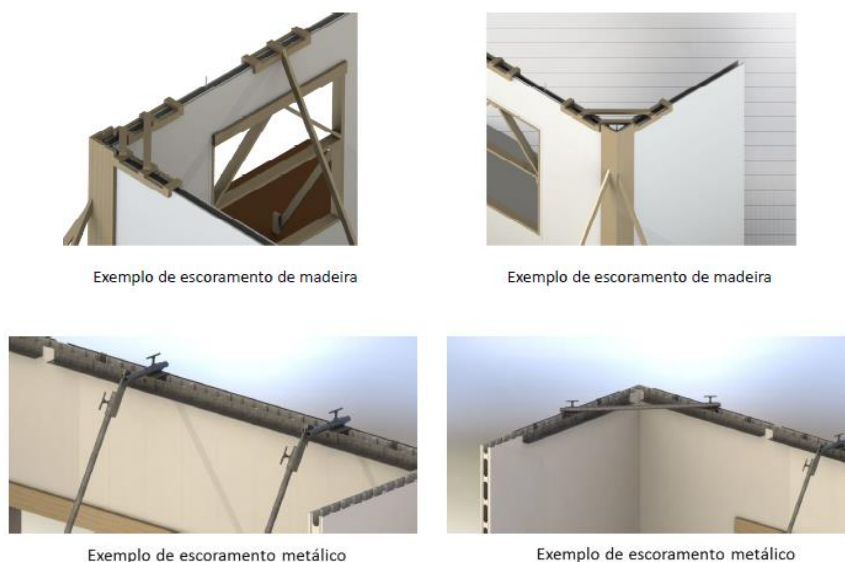
Figura 20 – Exemplos de Escoramento
