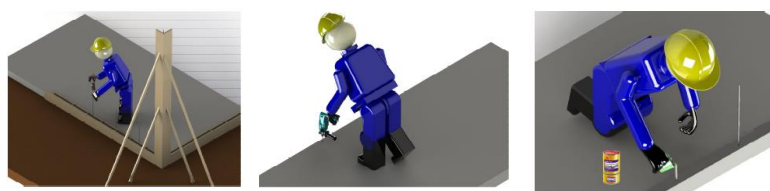
Figura 17 – Procedimentos iniciais para a montagens dos perfis
