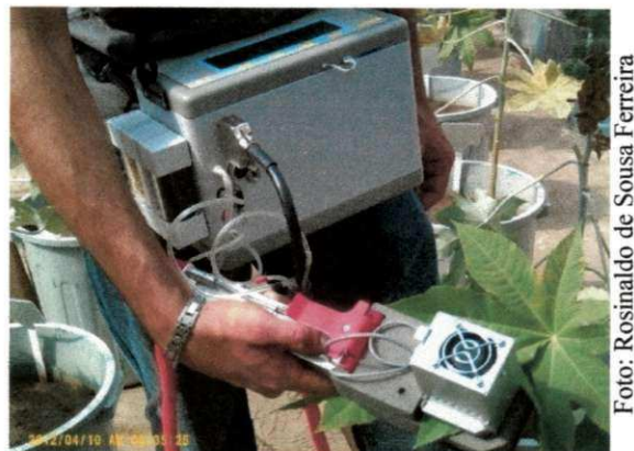
Figura 7: Avaliação de trocas gasosas utilizando-se o IRGA, na mamona, Campina Grande, PB, 2012
