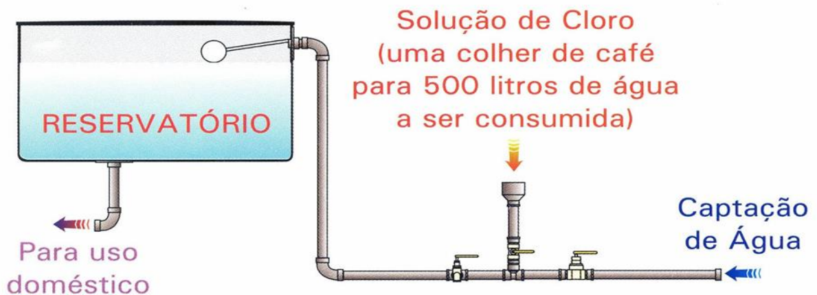
Figura 10 – Clorador Embrapa e seus componentes.
