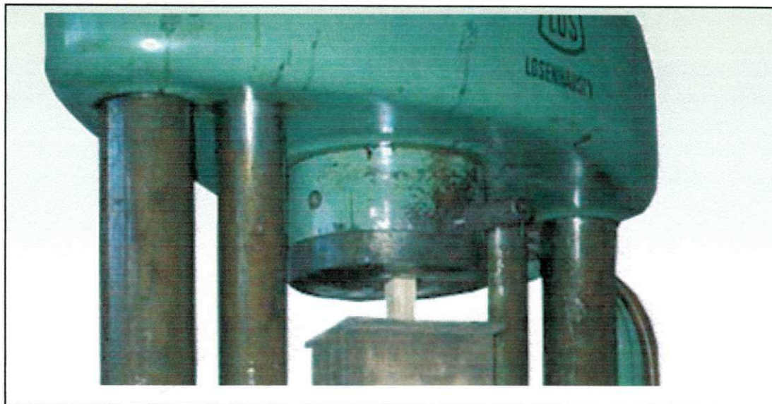
Figura 27 – Ensaio de compressão paralela às fibras.
