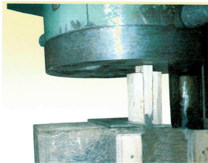
Figura 31 – Ensaio de cisalhamento na lâmina de cola.
