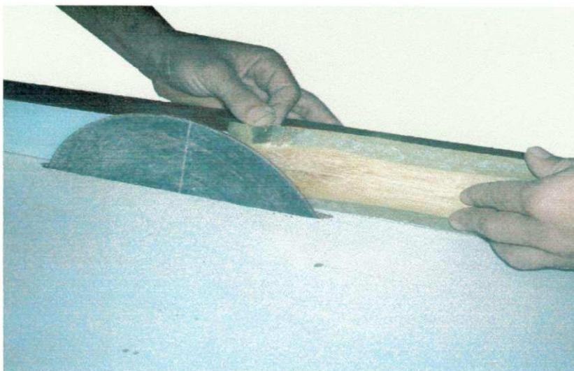
Figura 17 – Serra circular de bancada e detalhe da talisca usinada.
