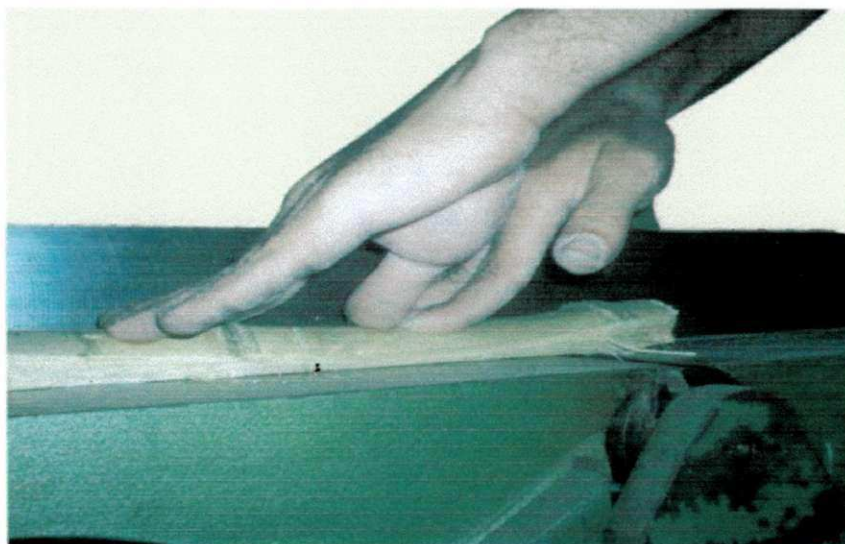
Figura 16 – Detalhe do aplainamento da talisca de bambu.
