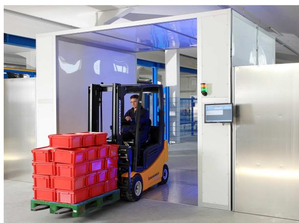
**Figura 2.9** – Conjunto de cargas atravessando uma estação de identificação.
