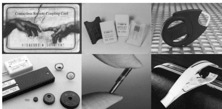
**Figura 2.3** – Diversos formatos de construção das etiquetas RFID.
