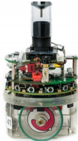
Figura 3.4: Vista lateral do robô e-puck apresentando o seus sensores e atuadores.
