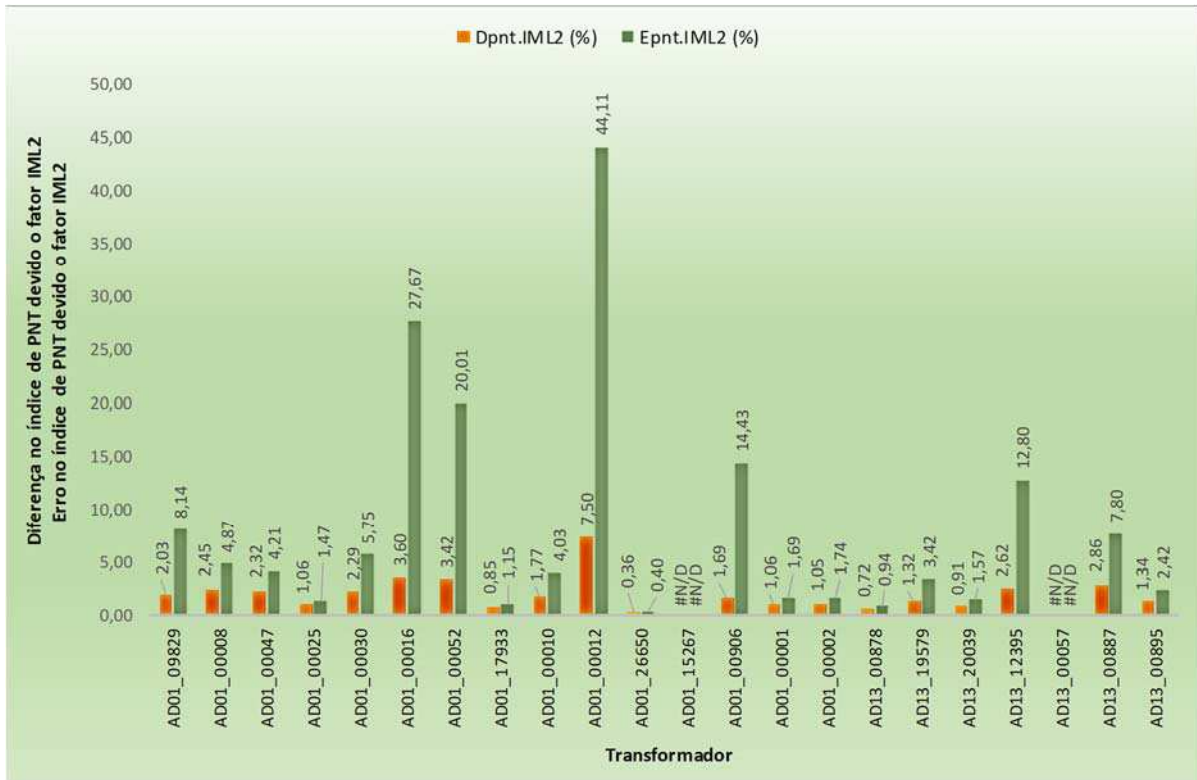
Gráfico 5 — Erros absoluto ( D_{\text{pnt,IML2}} ) e relativo percentual ( E_{\text{pnt,IML2}} ) no índice de PNT, devido ao fator IME x ILME – Caso 2 (IML2), em função do transformador monitorado.
