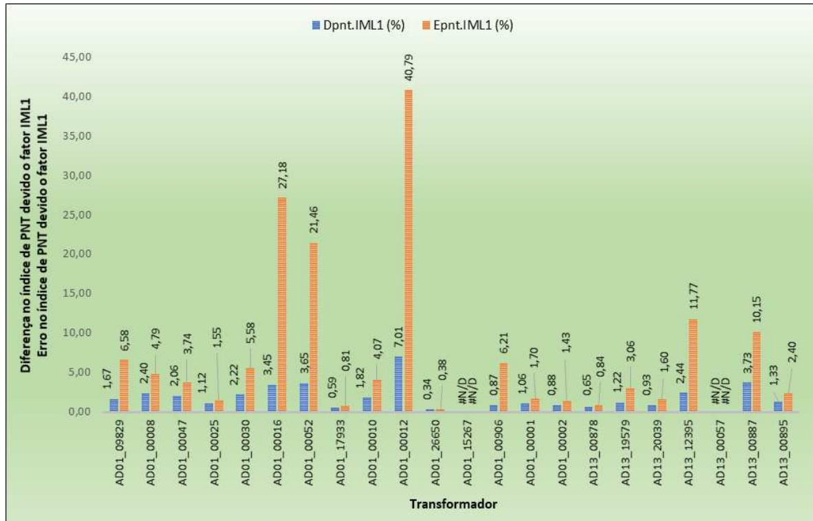
Gráfico 4 — Erros absoluto ( D_{pnt.IML1} ) e relativo percentual ( E_{pnt.IML1} ) no índice de PNT, devido ao fator IME x ILME – Caso 1 (IML1), em função do transformador monitorado.
