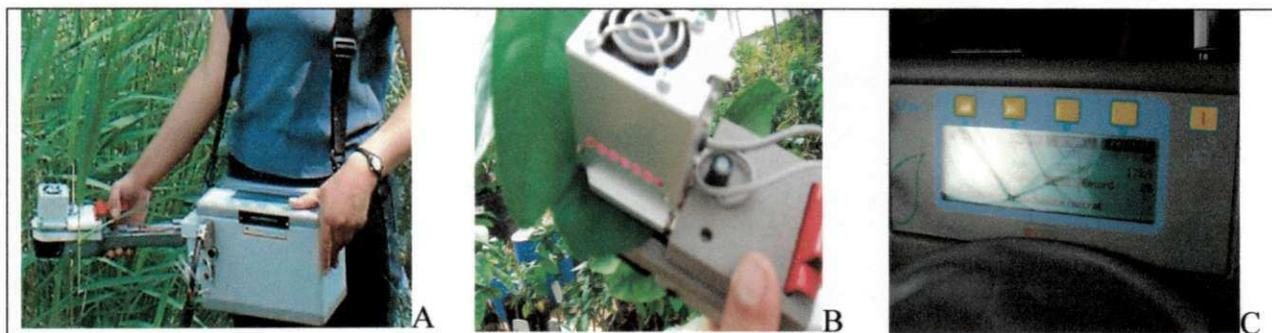
Figura 11: Uso do equipamento portátil de medição da fotossíntese LCPro+: (A) Visão geral do equipamento; (B) Pinça para acoplar a folha e obtenção de gases; (C) detalhe do painel do equipamento. Pombal, PB, 2010.
