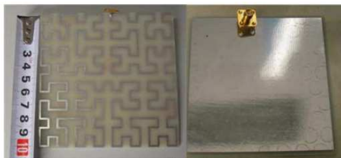
Figura 3.9 – Antena Hilbert fractal desenvolvida por Li et al. (2013), parte frontal e posterior, respectivamente.
