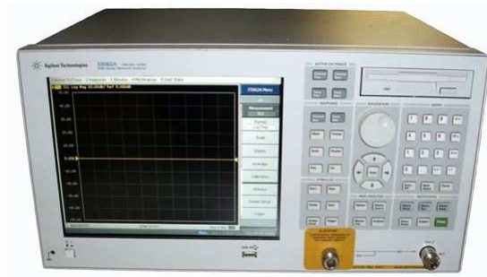
Figura 4.8 – Analisador de rede utilizado para estimar a potência transmitida/recebida pelas antenas.
