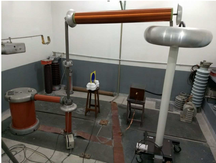
Figura 5.28 – Arranjo de medição de descargas parciais com antena confeccionada aplicada.
