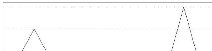
Pontos Equidistantes do Martelo Atenuados Pela Presença de Incrustação à Esquerda
