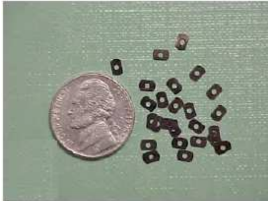
Figura 2.3: Fotografia de vários atuadores de LMF utilizados como interruptores de corrente de baterias. Fonte: [12].
