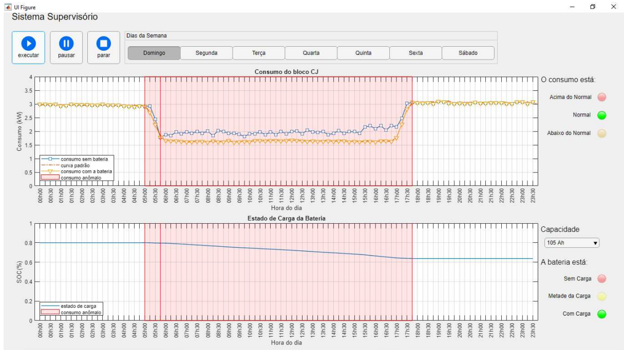
Figura 5.27 – Interface utilizando SAEB de 105 Ah
