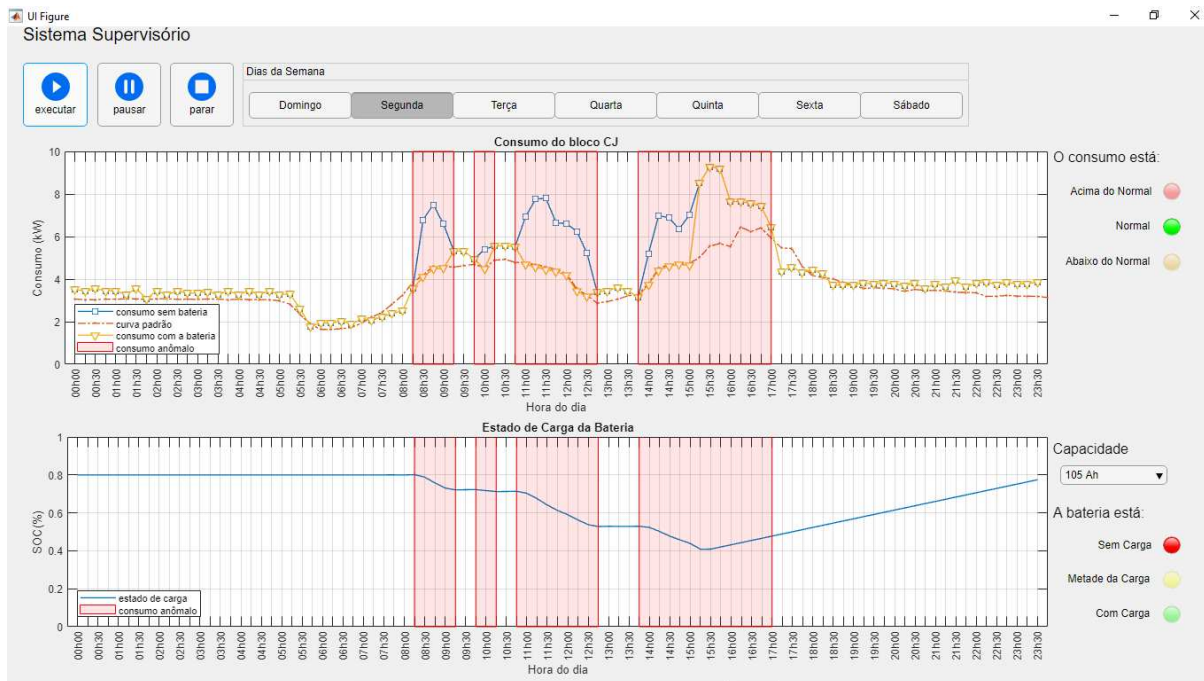
Figura 5.29 – Interface utilizando SAEB de 105 Ah
