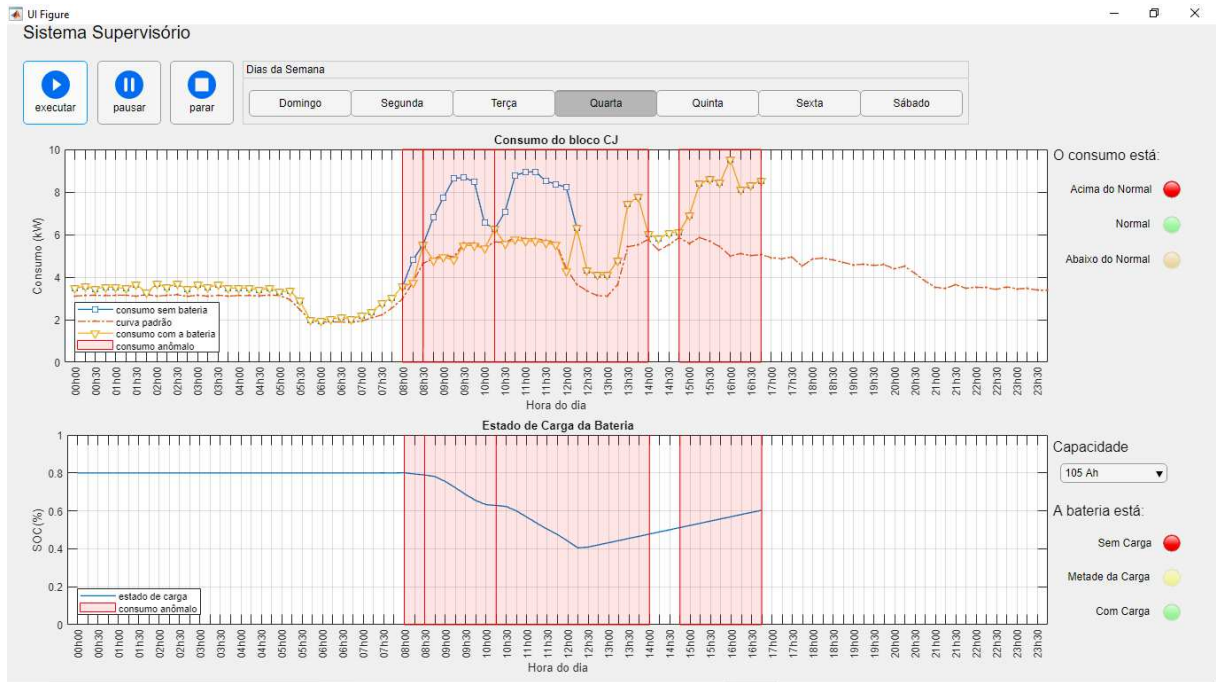
Figura C.13 – Interface utilizando SAEB de 105 Ah
