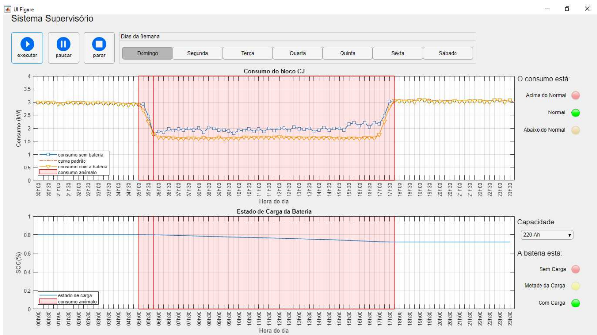
Figura 5.28 – Interface utilizando SAEB de 220 Ah
