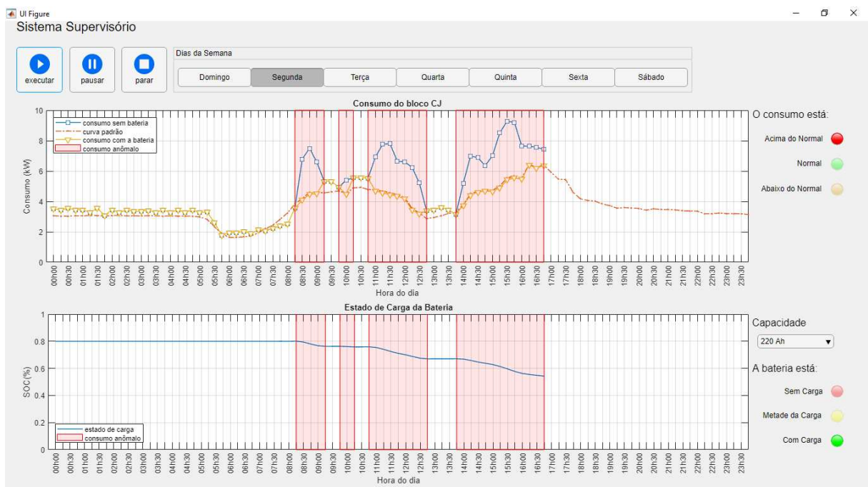
Figura 5.25 – Interface utilizando SAEB de 220 Ah
