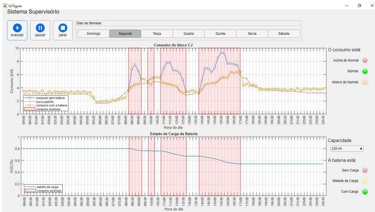
Figura 5.30 – Interface utilizando SAEB de 220 Ah
