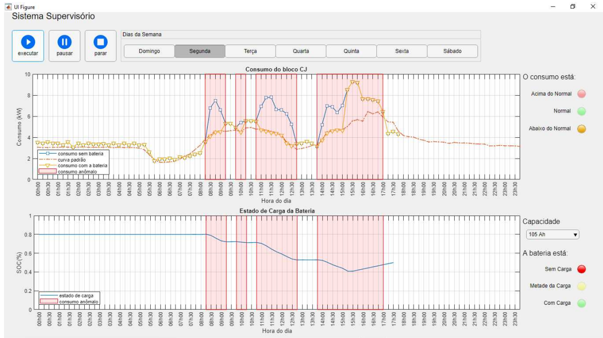
Figura 5.26 – Detecção de outras anomalias com SAEB de 105 Ah
