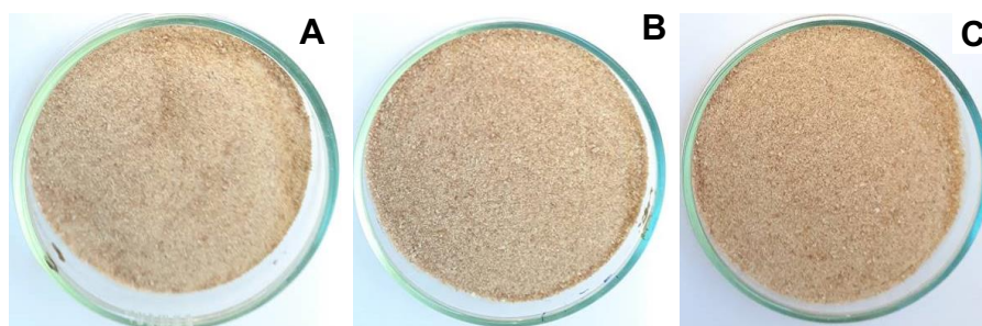
Figura 4. Farinhas do fruto do juazeiro obtidas por secagem em camada de espuma, a 50 – A , 60 – B e 70 °C – C .
