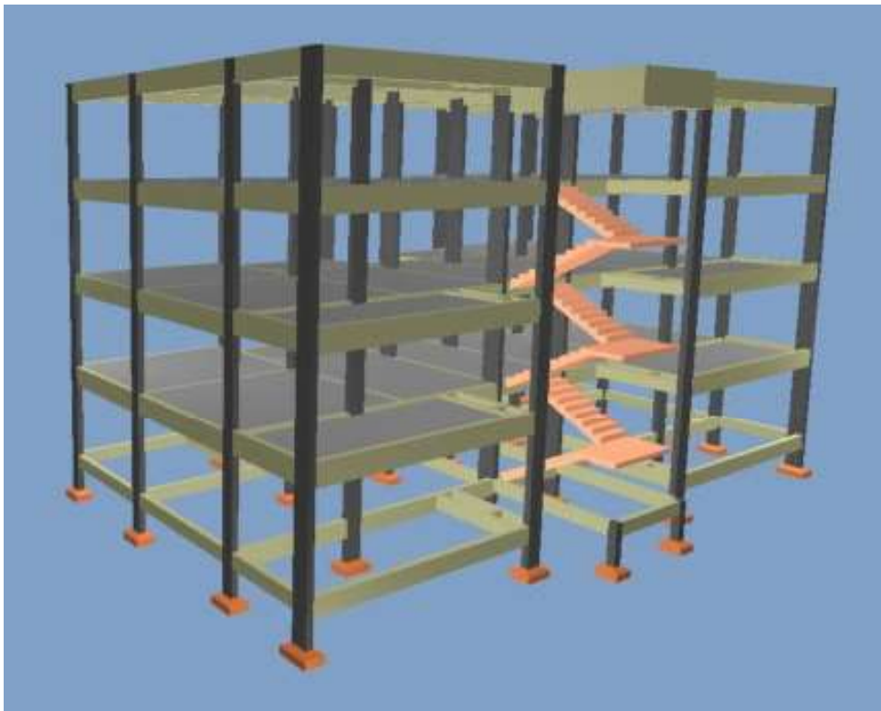
Figura 19 – Pórtico 3D gerado pelo eberick
