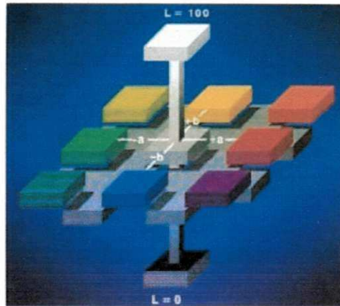
Figura 3.4 - Coordenadas retangulares do sistema Hunterlab (Fonte: Hunterlab, 2001)
